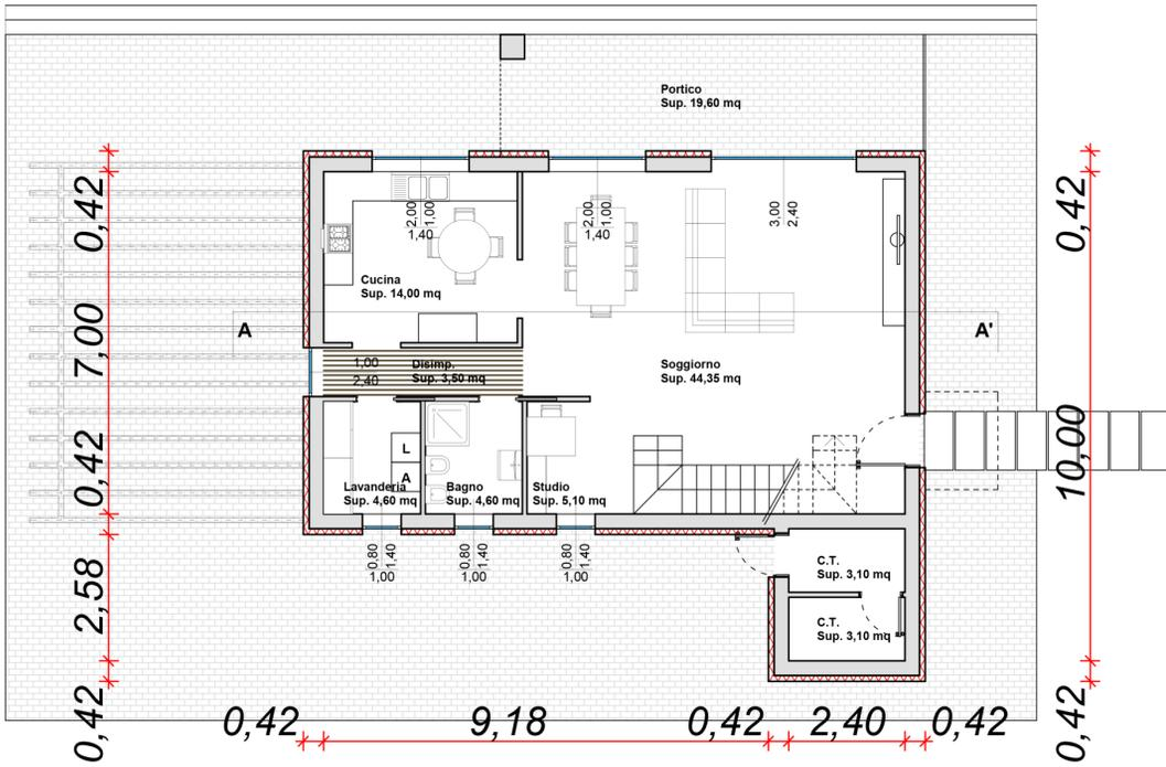
**PIANTA PIANO TERRA STATO DI PROGETTO SCALA 1:100**
